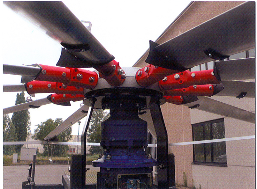
Particolare attacco pala per diametri 5-6-7-8 metri
